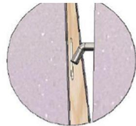
8. Ved montering av endemodul, hekt metallskiven (I) på kroken (H) og tre denne inn i det rektangulære hullet på endemodul. Tre deretter på metallskive (I) og fest mutter (J) i kroken på innsiden av endemodulrammen. Fest ikke for stramt.
